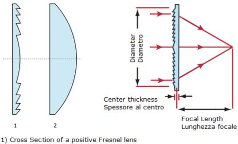
1) Sezione trasversale di una lente di Fresnel positiva
